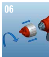
6.- Roscar la boquilla con fuerza hasta que la junta quede insertada en el pico
