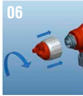
6.- 旋緊空氣帽，直到唇形密封件插入噴嘴
