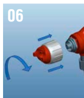
6.- Serrer fermement le chapeau d'air jusqu'à ce que le joint soit inséré dans la buse
