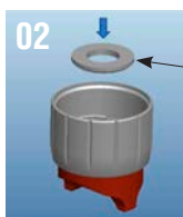
2.- Coloque a ferramenta dentro do bico de ar
