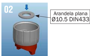
2.- Colocar el útil dentro de la boquilla
