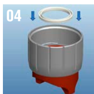
4.- Colocar junta en la posición indicada
